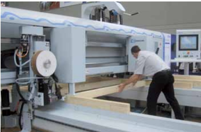
Automatisierte Riegelwerkserstellung / Automated framework generation
