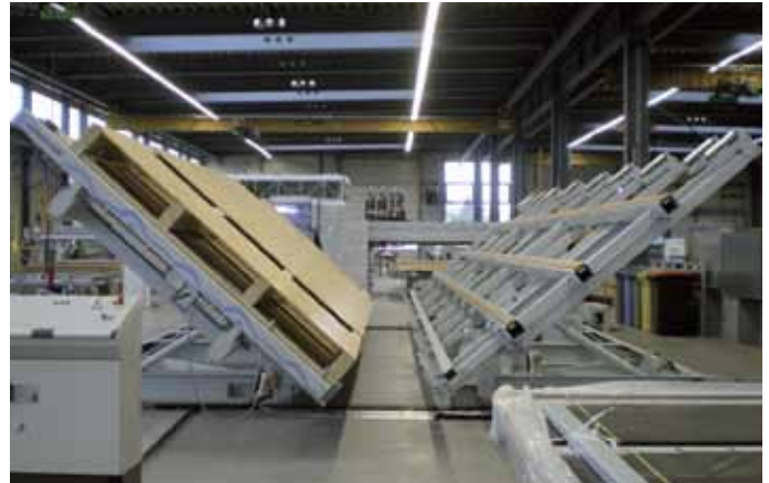
Das einseitig geschlossene Element wird mit Hilfe des Schmetterlingswenders gewendet After completion of the first element side the butterfly turning table turns the element
