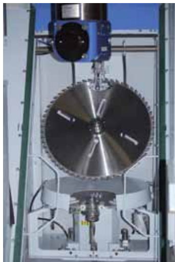
8-fach Werkzeugwechsler / 8-part tool changer
