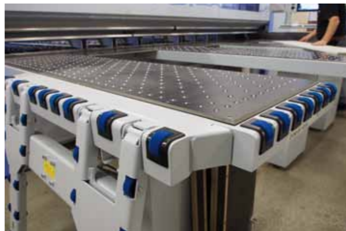
Qualität von Anfang an: Beflockte Rollen sorgen dafür, dass die Oberflächen auch sehr empfindlicher Materialien keinerlei Schaden beim Zuschnitt nehmen.
