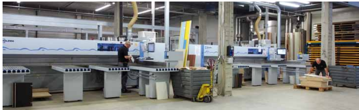
Stöcklin hat mit der Investition in zwei HOLZMA Plattenaufteilsägen vom Typ HPP 300 in Kombination mit dem Plattenlager TLF 411 die Weichen für die Zukunft gestellt. Im Fokus steht dabei besonders die konsequente und hochflexible Losgröße-1-Fertigung. Insgesamt hat das Unternehmen rund 650 000 Euro in das Projekt investiert.
