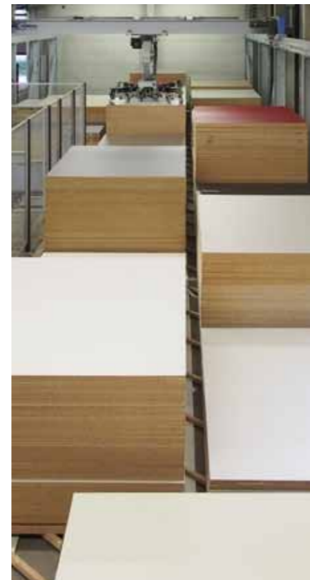
Das Plattenlager TLF 411 versorgt die beiden Sägen vollautomatisch und in definierter Reihenfolge.
