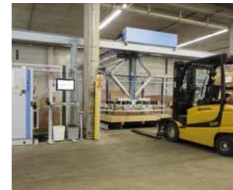
Das angelieferte und mit dem Stapler bereitgestellte Plattenmaterial wird automatisch eingelagert.
