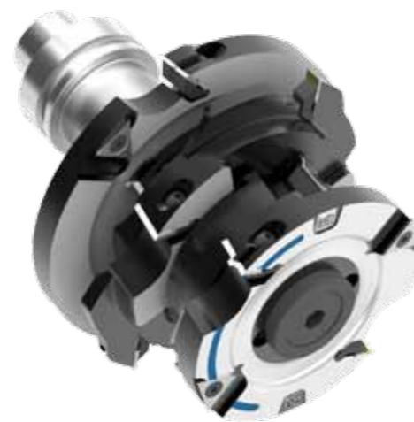
Die Leitz-Ingenieure haben bei der Entwicklung des neuen ProfilCut Q Premium auch einen Handling-Vorteil eingebaut. Haupt- und Nebenschneiden können im Satz getauscht werden (Foto: Leitz)
