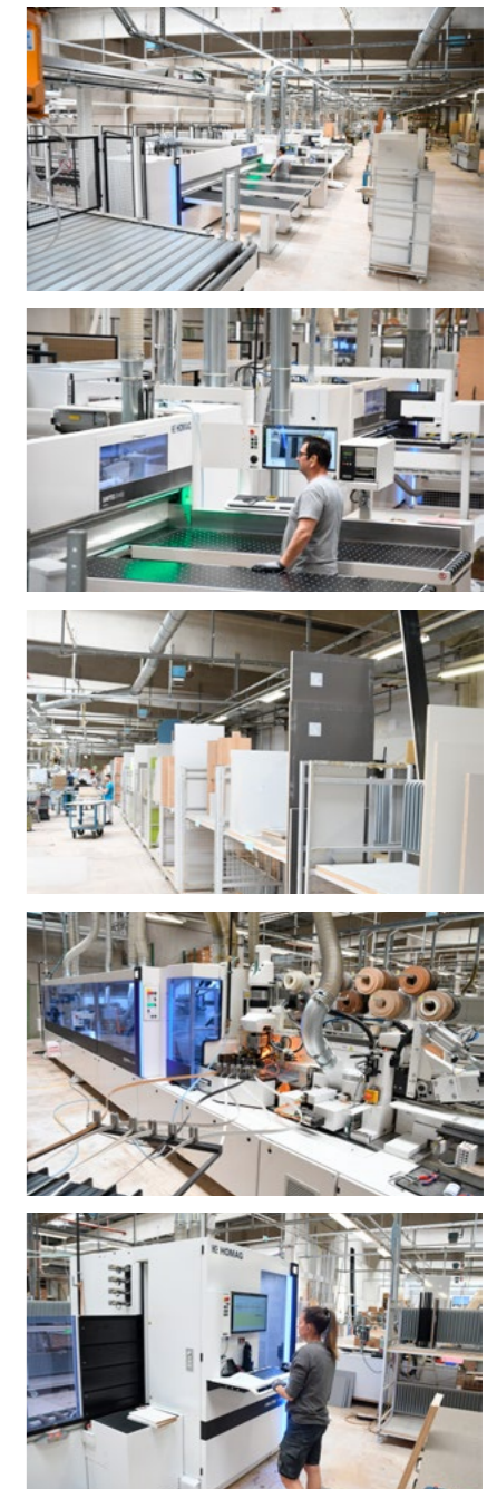
Bilder von oben nach unten: Blick in die Fertigung von Breitschopf: Die auftragsbezogene kommissionsweise Produktion, die nach dem Fließprinzip organisiert ist, hat der Losgröße-1-Hersteller redundant mit hoher Ausfallsicherheit aufgestellt.
