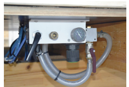
Juego neumático para el suministro de aire central y para el control de las vigas de sujeción C-PowerTec
