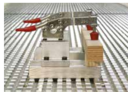
Speciální upínače hliníkový stůl matrix zaručuje přesné upevnění nejrůznějších upínacích prvků
