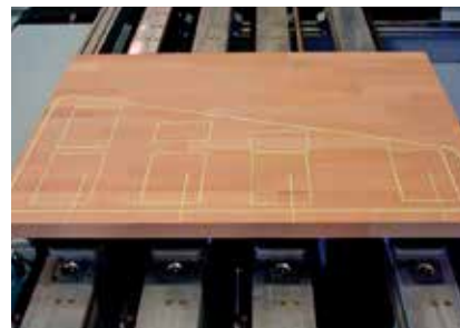
Laserový projektor zobrazuje polohu přísavek, i jednotlivé dílce s jejich obrysy. Vhodné např. pro výrobu schodišť, anebo tam, kde nelze obrobek zarovnat k referenčním dorazům.
