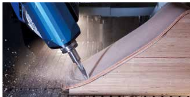
Frézování tvarovaného dřeva
