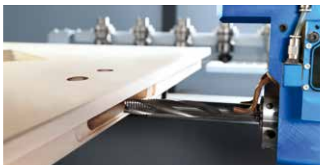
Vyfrézování dveřního zámku
