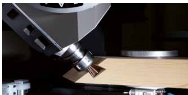
Frézování konstrukčních spojů
