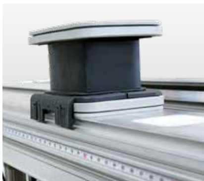
Pravítko k polohování přísavných zařízení.
