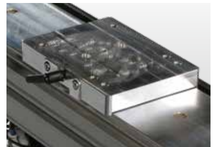
Modul podkladové desky k nasazení na konzolu, upíná se pomocí bočního šroubu (kličky) a umožňuje uchycení i složitých šablon pomocí předchystaných závitových otvorů a otvoru pro vývod vakua
