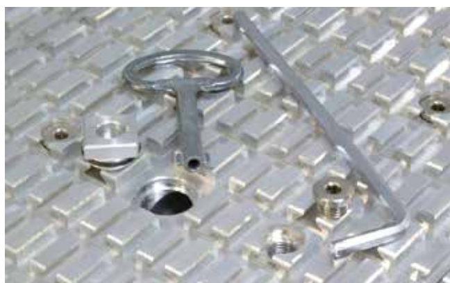
1" přípojky vakua s rychlým otvíráním pomocí klíče skříňového rozváděče, otvory vakuového systému s přesným závitem k upevnění upínacích prostředků
