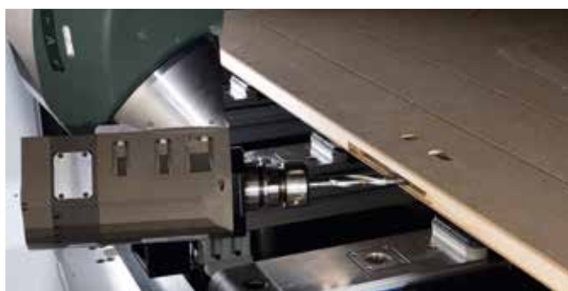
Frézování dveřního zámku
