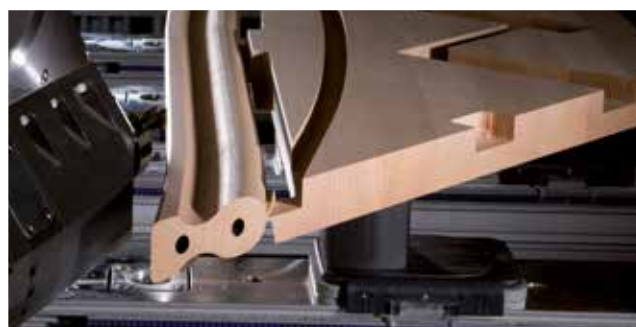
Výroba schodů a zábradlí
