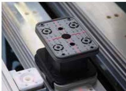
Laser – pomocí laserového kříže zobrazuje správnou polohu jednotlivých přísavek. Může sloužit i k zobrazení frézované kontrury.
