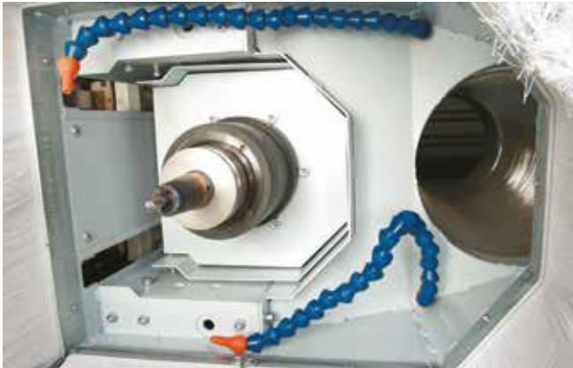
軸構成 11KW 水冷式HSK メインスピンドル。
