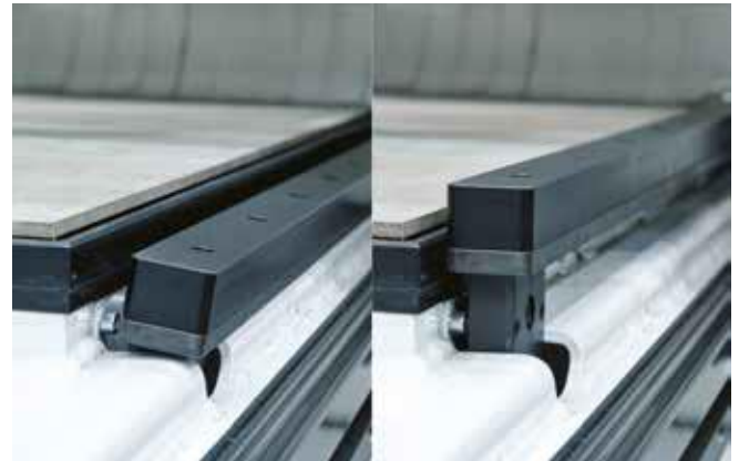
フェンスガイド (部材の自動払い出しコンセプト) 部材を安全に払い出します。
