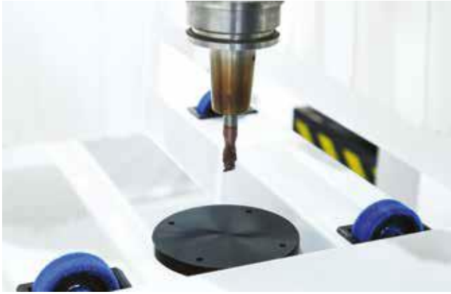
ツール測長 ツール交換後、ツールデータのファイルと 実測値を比較します。
