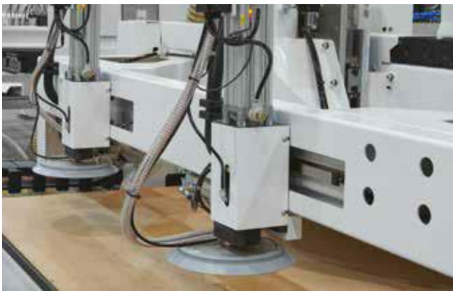
原板位置揃え用バキュームレバー (原板自動引き込み)
