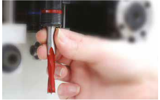
7,500 rpm 高速回転 キリ交換は、HOMAG社パテント、クイックチェンジ システムです。
