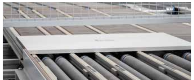
Materialübergabe aus dem SORTEQ R-200: Über das Kommissionier-Center verbundene Transportstrecken werden Werkstücke auftragsbezogen an den nachfolgenden Bearbeitungsschritt weitergeleitet.
