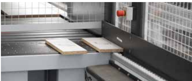
Manuelle Teilezufuhr: Am Handarbeitsplatz werden Werkstücke händisch an das Kommissionier-Center weitergeben. Diese werden im SORTEQ zwischengelagert und sortiert an den nächsten Fertigungsschritt weitergeleitet.
