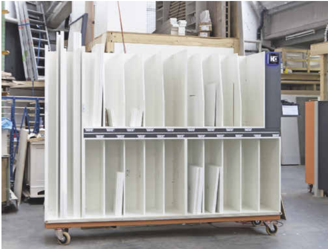
Das Sortierregal wurde in der Schreinerei nach einem Bauplan von Homag selbst hergestellt
