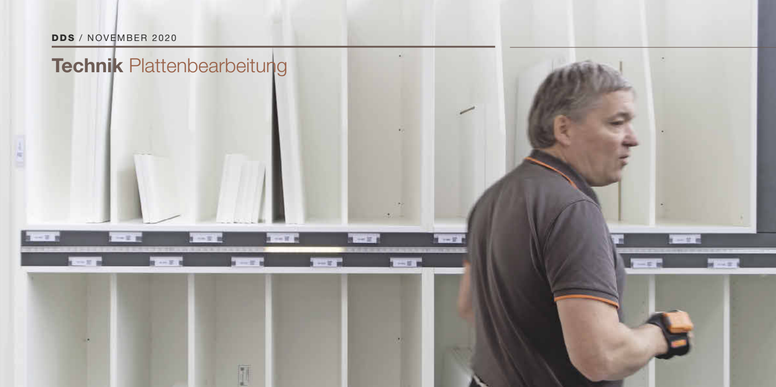
Ein Fach ist mit einem weißen Lichtband markiert. In dieses Fach hat Mario Esch gerade ein Korpusteil gestellt
