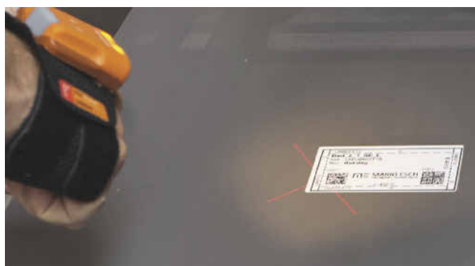
Noch während das Werkstück die Maschine durchläuft, liest er mit seinem Handschuhscanner den QR-Code auf dem Etikett ein
