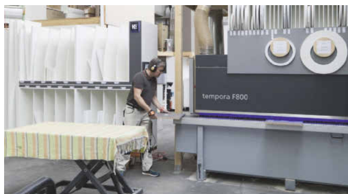
Mario Esch steht am Auslauf der Kantenleimmaschine und sortiert jedes fertige Teile in das mit einem Lichtband markierte Fach
