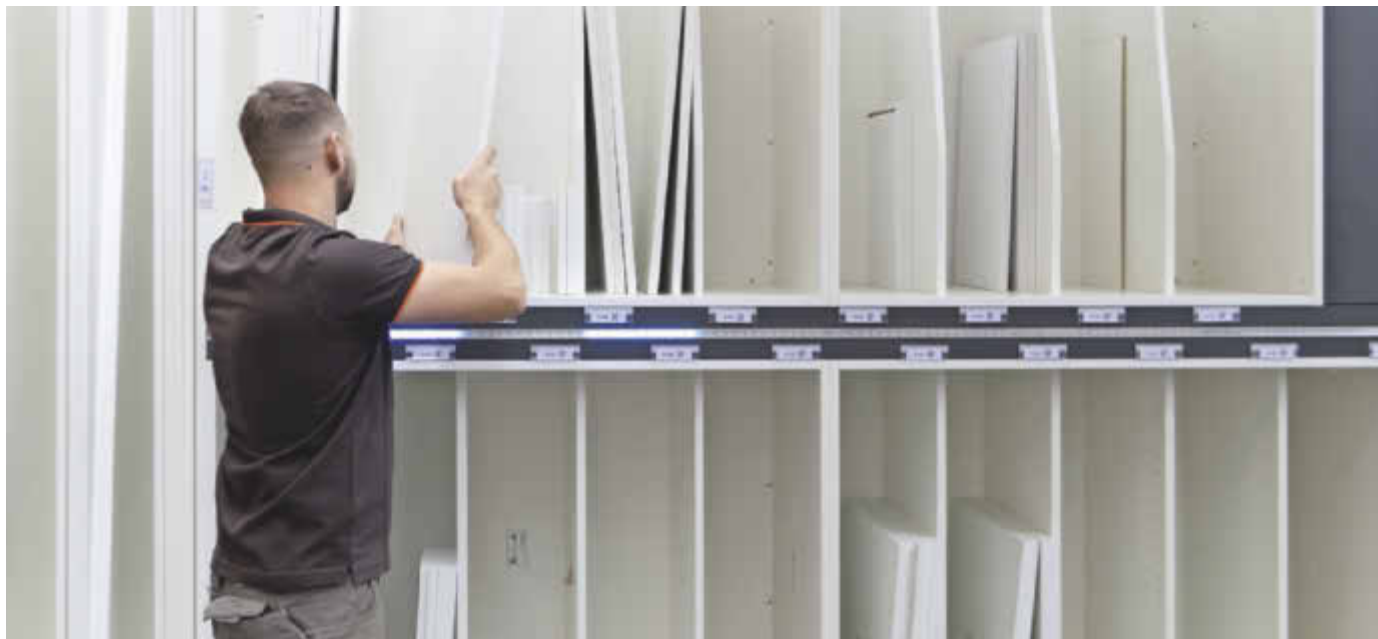
Schreiner Geselle Lars Selig montiert die Schränke der Kommission Pfuhl. Blaue Lichtbänder zeigen ihm die Teile für den nächsten Korpus
