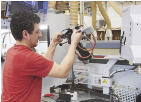
Schneller Kleberwechsel: Lehle verfügt über drei zügig und einfach auswechselbare Leimbecken.
