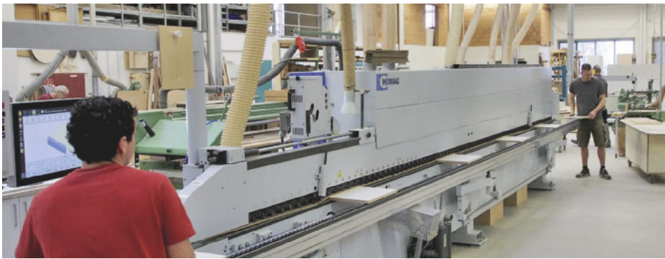
Die Homag Ambition 2274 AirTec arbeitet mit einer Vorschubgeschwindigkeit von bis zu 20 m/min, wobei die minimale Werkstücklänge 400 mm beträgt. Werkstückdicken von 8 bis 60 mm sind möglich.
